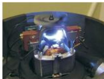
praca z uszkodzonym silnikiem
