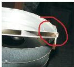
pompa ssąca - brudne łopatki
