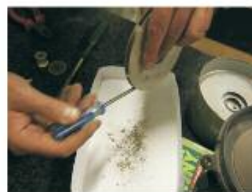
pompa ssąca - brudne łopatki
