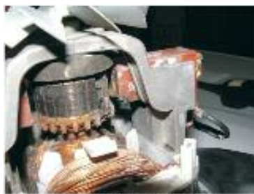
silnik - uszkodzony komutator
